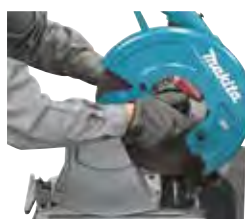
Cambio del disco abrasivo sin herramientas adicionales
